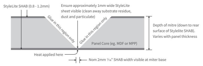
DIAGRAM: STYLELITE MITRED COMPONENT READY FOR HEAT BENDING
